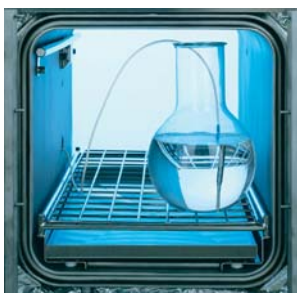
Sterilizzazione dei liquidi - bottiglia di riferimento con sonda di temperatura
